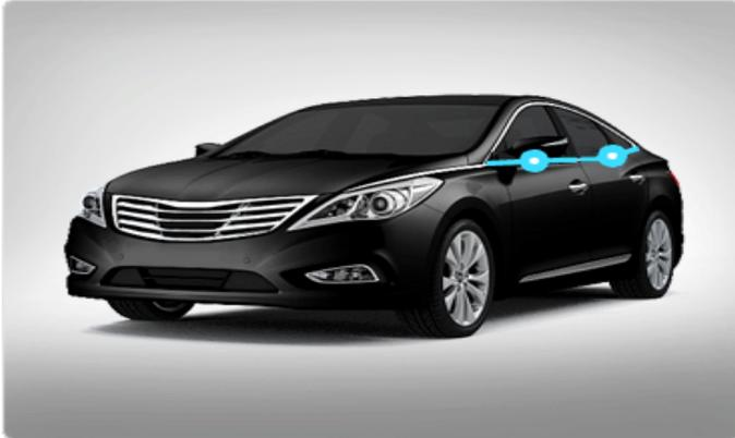
DOOR PNL INNER 부에 장착되며 DOOR GLASS면을 지지하여 GLASS진동 및 파손을 방지하며, DOOR GLASS면의 오염물질 및 빗물 과다 유입을 방지하고 DOOR GLASS와 DOOR PNL사이를 장식합니다.
